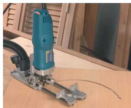
Фрезерование окружности при помощи циркульного приспособления.
