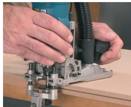
Фрезерование пазов под Т-образный врезной кант.
