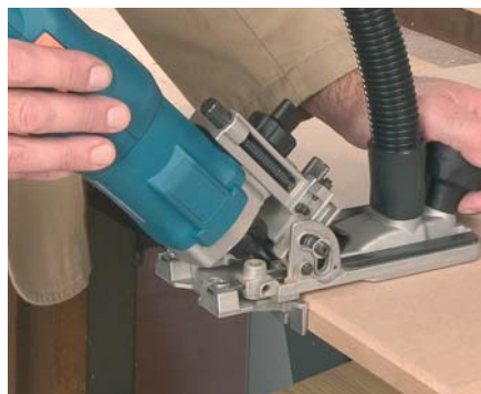
Фрезерование фаски стандартной фрезой.
