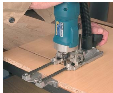
Фрезерование пазов под Т-образный врезной кант.
